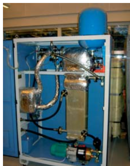
Det blå skåpet hade en turbin med effekten 6 kW och varvtalet 45 000 rpm.
