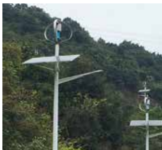
En vanlig syn i Shenzen där belysningen drivs med sol och vind och är LED-baserad.
